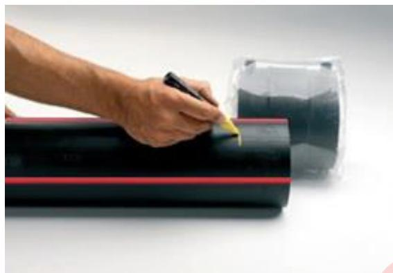
Рис.5 Отметка длины зачистки маркером
